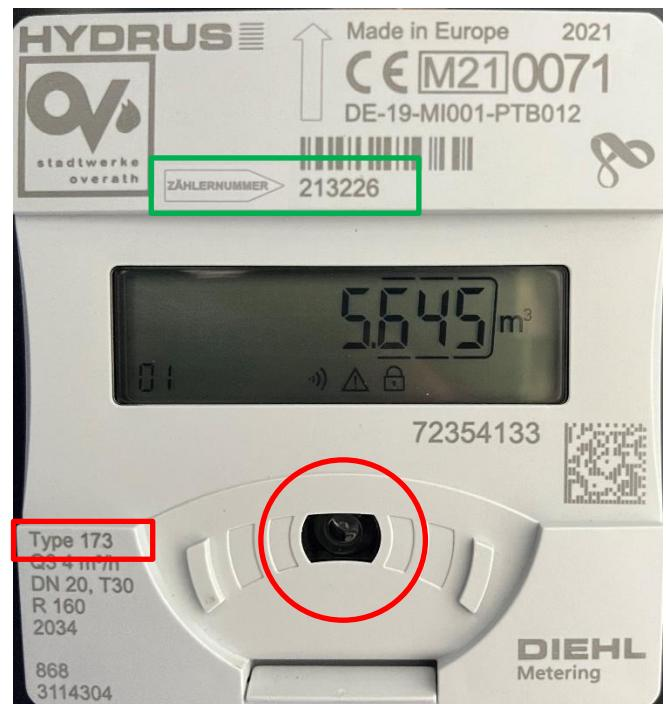
Die Anzeige des aktuellen Zählerstandes ist erkennbar am kleinen Pfeil, der auf die **m<sup>3</sup>** zeigt.
